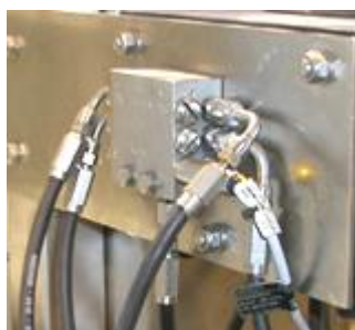
Possibilité de montage d'un détecteur de piston
